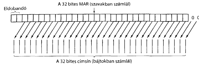
4.4. ábra. A MAR bitjeinek leképezése a címsínnre
